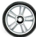
Колеса легко снимаются без использования инструментов. Для снятия колеса с оси нажмите на фиксатор, расположенный на наружной части колеса у оси, и потяните. Чтобы обеспечить лучшее вращение и долгий срок службы колес, периодически смазывайте втулки, например, неокрашенным силиконовым спреем или белой тефлоновой смазкой.
