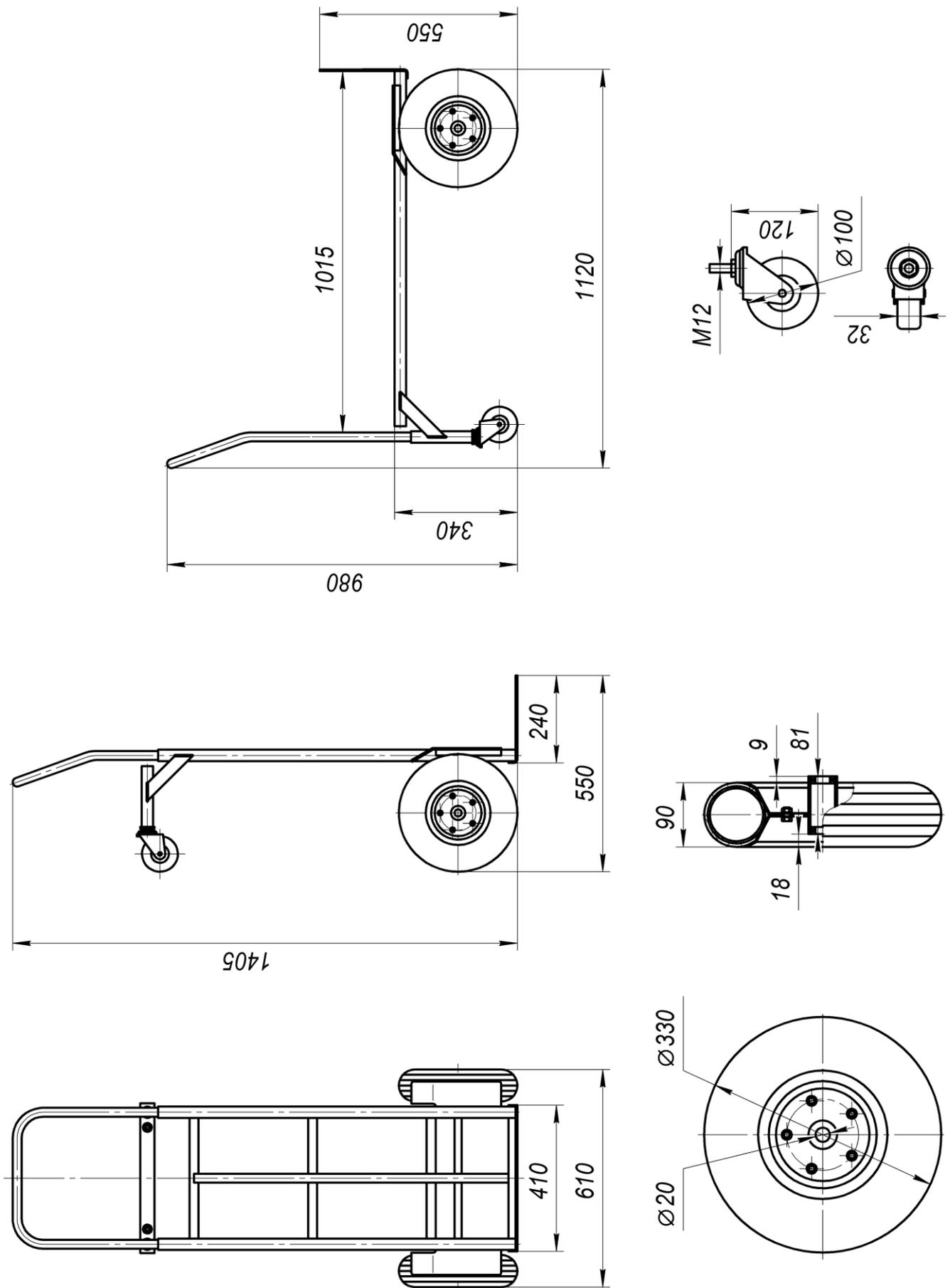
Рис.1. Размеры тележки
