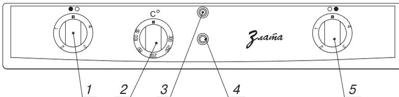
1 - ручка переключателя мощности левой электроконфорки; 2 - ручка термостата; 3 - сигнальная лампа включения электроконфорок; 4 - сигнальная лампа включения электронагревателей электрошкафа жарочного; 5 - ручка переключателя мощности правой электроконфорки.
