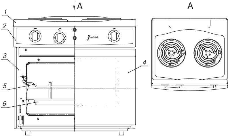
1 — плита с электроконфорками; 2 — панель блока управления; 3 — электрошкаф жарочный; 4 — дверца электрошкафа жарочного; 5 — решётка; 6 — противень.
