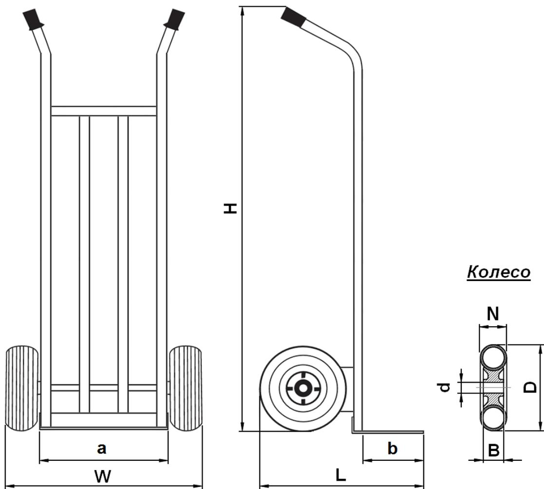
Рис.1. Размеры тележки НТ1830
